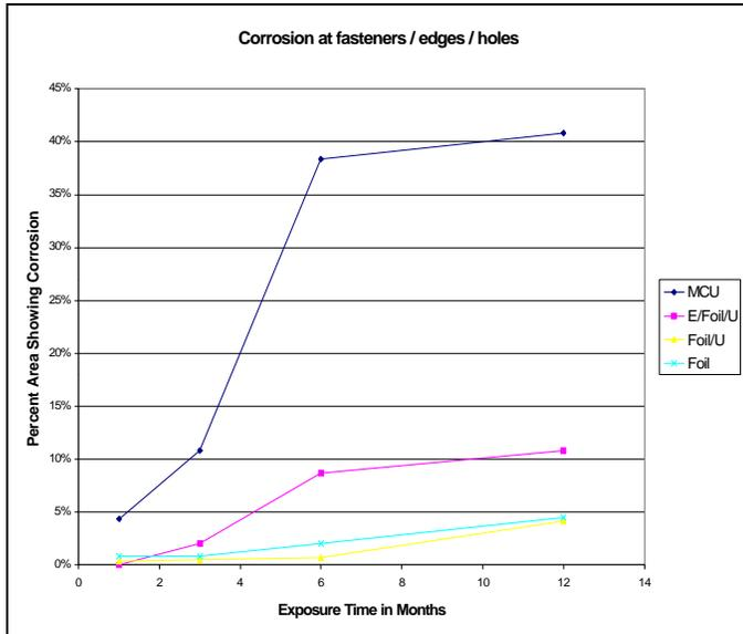
**GRAPH 2. COMPARISON OF CORROSION AT IRREGULAR SURFACES FOR THE TEST BEAMS UNDER MARINE ATMOSPHERE EXPOSURE.**
