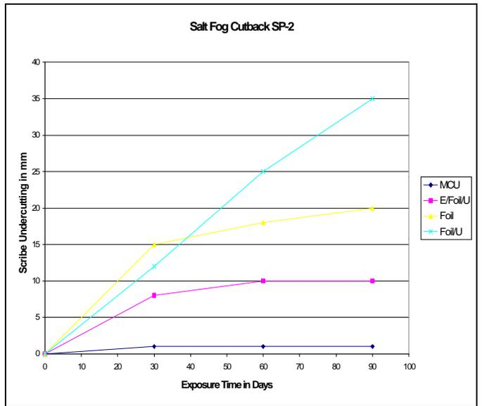
**GRAPH 7. COMPARISON OF SCRIBE CUTBACK RESULTS OVER AN SP-2 SURFACE FOR THE SALT FOG TEST.**
