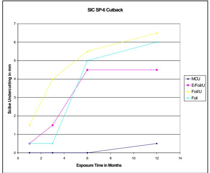
**GRAPH 5. COMPARISON OF SCRIBE CUTBACK RESULTS OVER AN SP-6 SURFACE FOR THE TEST BEAMS UNDER MARINE ATMOSPHERE EXPOSURE.**
