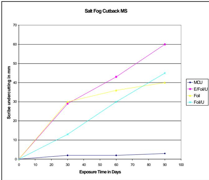
**GRAPH 6. COMPARISON OF SCRIBE CUTBACK RESULTS OVER A MILL SCALE SURFACE FOR THE SALT FOG TEST.**
