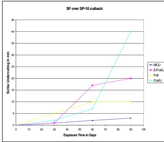
**GRAPH 8. COMPARISON OF SCRIBE CUTBACK RESULTS OVER AN SP-10 SURFACE FOR THE SALT FOG TEST.**
