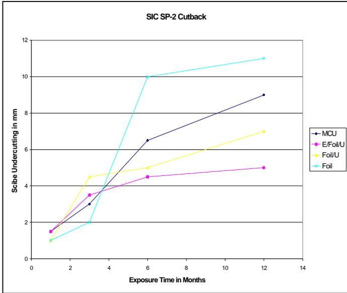
**GRAPH 4. COMPARISON OF SCRIBE CUTBACK RESULTS OVER AN SP-2 SURFACE FOR THE TEST BEAMS UNDER MARINE ATMOSPHERE EXPOSURE.**
